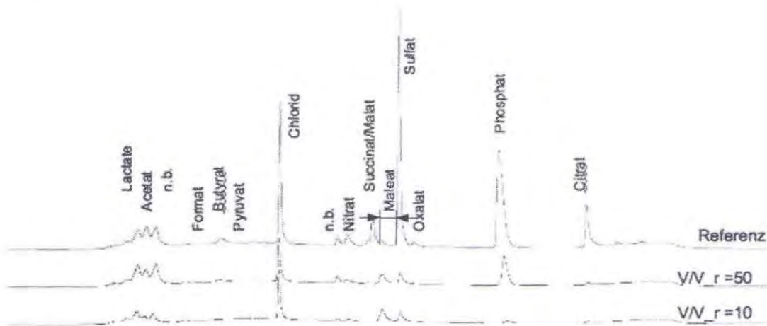
Abbildung 9: Ionenchromatogramm der Proben zu Beginn der Adsorption V_R = 10 (unten), bei V_R = 50 (mitte) sowie des unbehandelten Bieres (oben). Sowohl nach Durchlauf des 10- als auch dem 50-fachem Reaktorvolumen ist die Bernsteinsäure (Succinat) nicht nachzuweisen. Andere Ionen sind bei V_R 50 bereits wieder vorhanden. Das Chromatogramm wurde mit Proben aus Lauf 4 erstellt. Die Pfeile weisen auf den Punkt im Chromatogramm hin, an dem normalerweise Maleat sich befindet (Eine Dicarbonsäure mit ähnlichem physiologischem Effekt wie Bernsteinsäure).
